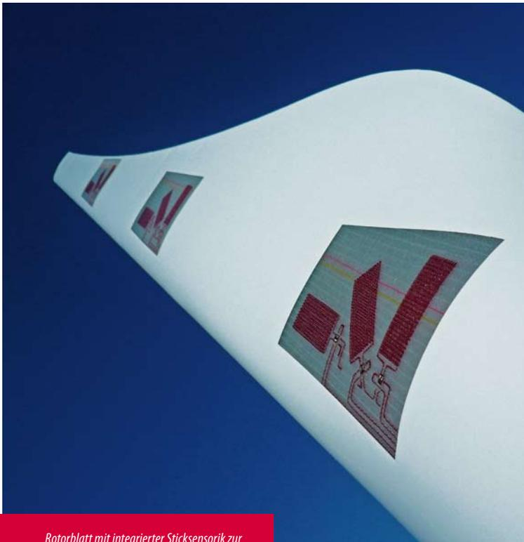
Rotorblatt mit integrierter Sticksensorik zur Zustandsüberwachung
