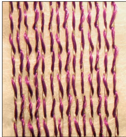
Bild 1: Sticktechnologisch verlegter Sensordraht. (Alle Bilder: LSE-Lightweight)
