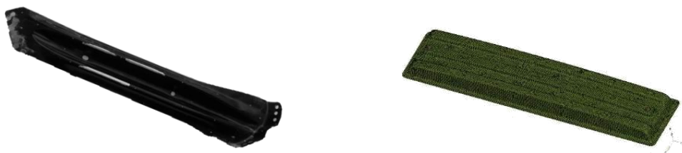
Abb.2: Seitenaufprallträger: li. Stahlvariante, re. Erste Modellentwicklung
