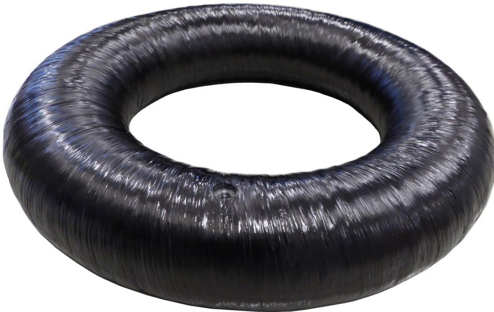
*Toroidaler Composite Druckbehälter (Bild LSE GmbH, TU Chemnitz Institut für Strukturleichtbau)*
