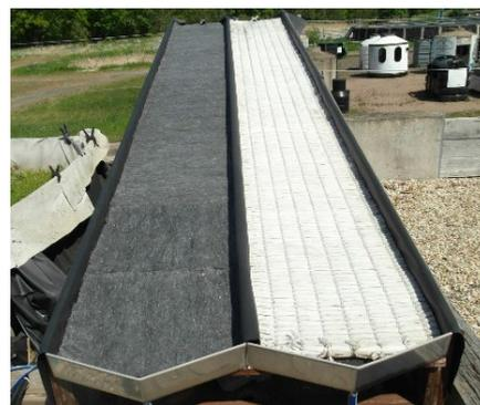
Vorversuch: Reinigungsleistung von Grauwasser mit Vliesstoff (links) und einer gewirkten Struktur (rechts), © Katy Bernhard, UFZ
